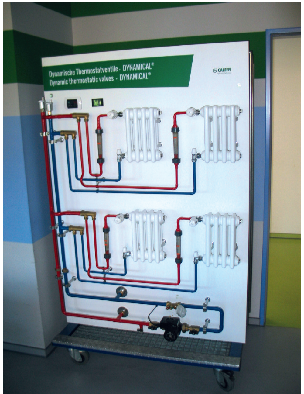
Bild 6 • Für einen der Seminarräume hat Caleffi eine Demonstrationswand mit dynamischen Thermostatventilen zur Verfügung gestellt.
