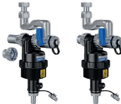
Bilder 10 + 11 • Ähnlich konstruiert sind die Unterputzversionen für die Wandheizkessel von Junkers (links) und Brötje, die ebenfalls ab Werk mit einem Drei-Wege-Kugelhahn ausgestattet sind. Anschlussmaße Junkers: AS 3/4" AG lang und kurz sowie KS 3/4" IG Überwurf. Brötje: AS: 3/4" AG kurz und KS in 3/4" IG Überwurf.
