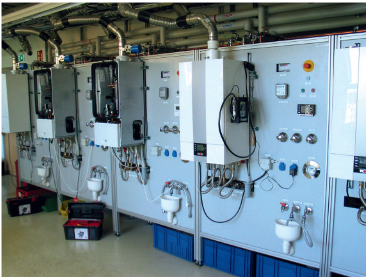
Bilder 4+ 5 • In der Praxiswerkstatt mit fest installierten und voll funktionsfähigen Wandheizkesseln aller führenden Hersteller wurde die Praxistauglichkeit der verschiedenen Versionen des Dirtmag Slim getestet.
