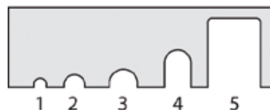
Sviluppo piano del sistema interno di preregolazione
