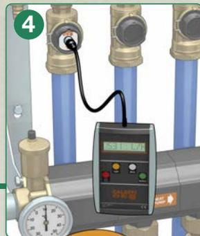
3. introduzir o sensor de medição e reabrir a válvula
