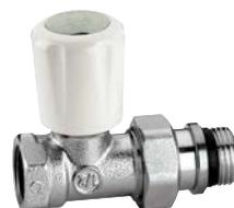
Robinet droit thermostatisable, pouvant recevoir une tête électrothermique ou thermostatique. Chromé. Pour tube acier. Pmax d'exercice : 10 bar. Plage de température : 5÷100°C.
