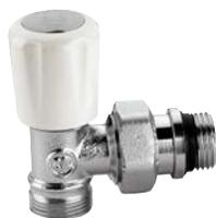
Robinet équerre thermostatisable, pouvant recevoir une tête électrothermique ou thermostatique. Chromé. Pour tube cuivre, plastique simple et multicouche. Pmax d'exercice : 10 bar. Plage de température : 5÷100°C.
