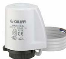
Tête électrothermique. Avec indicateur de position d'ouverture. **Raccord rapide avec adaptateur à clip.** Normalement fermée. Alimentation : 230 V (~) ou 24 V (~)/(=). Puissance : 3 W, courant d'appel : ≤ 1 A. Tmax ambiante : 0÷50°C. Indice de protection : IP 54.
