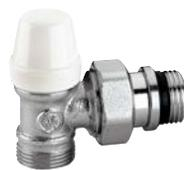
Coude de réglage. Chromé. Pour tube cuivre, plastique simple et multicouche. Pmax d'exercice : 10 bar. Plage de température : 5÷100°C.
