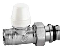
Té de réglage. Chromé. Pour tube cuivre, plastique simple et multicouche. Pmax d'exercice : 10 bar. Plage de température : 5÷100°C.
