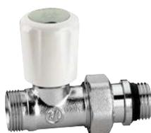
Robinet droit thermostatisable, pouvant recevoir une tête électrothermique ou thermostatique. Chromé. Pour tube cuivre, plastique simple et multicouche. Pmax d'exercice : 10 bar.
