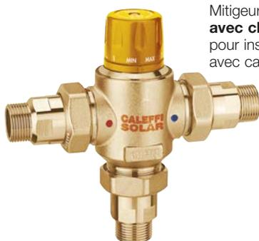
Mitigeur thermostatique avec clapets anti-retour pour installations solaires, avec cartouche extractible. Corps en laiton. Raccords unions filetés mâles. Pmax d'exercice : 14 bar. Tmax d'entrée: 110°C.
