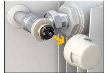
Soulever la bague de manœuvre (A) du dispositif de pré-réglage et tourner l'axe de commande (B) pour sélectionner une position. Attention à ne pas sortir complètement la bague (A) de l'axe de commande (B). **Centrer correctement le numéro choisi (C) sur l'ouverture (D).**
