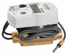
Compteur d'énergie chauffage et/ou rafraîchissement compact à ultrasons. Longueur sonde de départ 1 m. Alimentation : batterie au lithium (durée 10 ans). Indice de protection : IP 54. PN 16.
