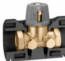
Vanne d'arrêt et de pré-régulation. Corps en laiton antidéminéralisation. Avec prise de pression pour le raccordement du tube capillaire. **Avec coque d'isolation.** Pmax d'exercice : 16 bar. Plage de température : -10÷120°C. Pourcentage maxi de glycol : 50%.
