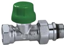
Robinet thermostatique dynamique droit pouvant recevoir une tête thermostatique et électrothermique. Chromée. Pour tube en fer. Pmax d'exercice : 10 bar. Plage de température : 5÷95°C.
