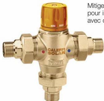
Mitigeur thermostatique pour installations solaires, avec cartouche extractible. Corps en laiton. Raccords unions filetés mâles. Pmax d'exercice : 14 bar. Tmax d'entrée: 110°C.
