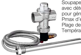
Soupape de sécurité thermique, avec détecteur à double sécurité, pour générateurs à combustible solide. Pmax d'exercice: 10 bar. Plage de température : 5÷110°C. Température de tarage : 98°C (0/-4°C).
