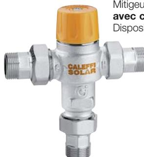
Mitigeur thermostatique réglable, avec clapets anti-retour et filtres. Dispositif avec sécurité anti-brûlure. Corps en laiton antidéminéralisation CR. Chromé. Raccords unions filetés mâles. Conforme aux normes NF 079 doc. 8, EN 15092, EN 1111, EN 1287. Pmax d'exercice : 10 bar. Tmax d'entrée : 100°C.
