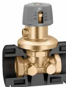
Régulateur de pression différentielle. Corps en laiton antidéminéralisation. Avec tube capillaire pour raccordement à la vanne sur le circuit de départ. **Avec coque d'isolation.** Pmax d'exercice : 16 bar. Plage de température : -10÷120°C. Pourcentage maxi de glycol : 50%. Longueur tube capillaire Ø 3 mm : 1,5 m.
