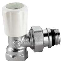
Robinet équerre thermostatisable, pouvant recevoir une tête électrothermique ou thermostatique. Chromé. Pour tube acier. Pmax d'exercice : 10 bar. Plage de température : 5÷100°C.
