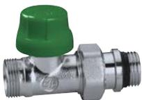
Robinet thermostatique dynamique droit pouvant recevoir une tête thermostatique et électrothermique. Chromée. Pour tube cuivre, plastique simple et multicouches. Pmax d'exercice : 10 bar. Plage de température : 5÷95°C.
