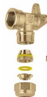
Coude avec fixation murale. Pour tubes cuivre recuit ou écroui, laiton, acier doux ou inox. Avec double joints O-Ring. Homologué EN 1254-4.
