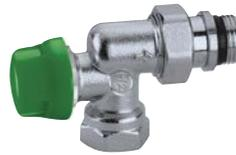
Robinet thermostatique dynamique équerre inverse pouvant recevoir une tête thermostatique et électrothermique. Chromée. Pour tube en fer. Pmax d'exercice : 10 bar. Plage de température : 5÷95°C.
