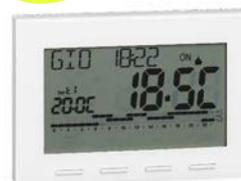
Thermostat programmable digital. Programmation hebdomadaire. 3 niveaux de températures + antigel. Programmation minimale de 30 minutes. Fonctionnement ON/OFF avec différentiel réglable de 0,2 à 2°C ou proportionnel. Commutateur ÉTÉ - HIVER. Température réglable par pas de 0,1°C. Contact sec de sortie : 5 (3) A / 250 V. Indice de protection : IP 30. **Classe:** I-IV [Ecodesign Directive].
