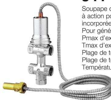
Soupape de sécurité thermique, à action positive, avec réinjection d'eau froide incorporée. Pour générateur à combustible solide. Pmax d'exercice : 6 bar. Tmax d'exercice : 110°C. Plage de température : 5÷110°C. Plage de température ambiante : 1÷50°C. Température de tarage : 100°C (0/-5°C).
