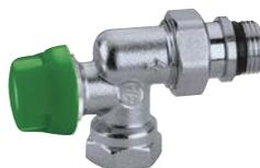
Robinet thermostatique dynamique équerre inverse pouvant recevoir une tête thermostatique et électrothermique. Chromée. Pour tube en fer. Pmax d'exercice : 10 bar. Plage de température : 5÷95°C.
