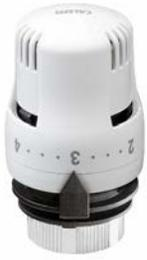
Tête thermostatique pour robinets de radiateurs thermostatés; capteur incorporé avec élément sensible liquide. Pour robinets séries 220, 221, 222, 223, 224, 225, 226 et 227. Échelle de réglage graduée de \* à 5 correspondant à une plage de température de 7°C à 28°C.
