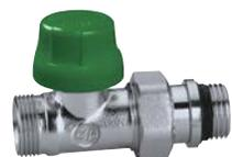
Robinet thermostatique dynamique droit pouvant recevoir une tête thermostatique et électrothermique. Chromée. Pour tube cuivre, plastique simple et multicouches. Pmax d'exercice : 10 bar. Plage de température : 5÷95°C.
