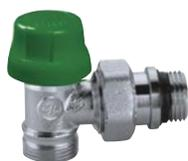
Robinet thermostatique dynamique équerre pouvant recevoir une tête thermostatique et électrothermique. Chromée. Pour tube cuivre, plastique simple et multicouches. Pmax d'exercice : 10 bar. Plage de température : 5÷95°C.
