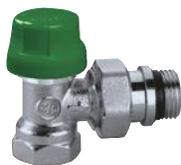
Robinet thermostatique dynamique équerre pouvant recevoir une tête thermostatique et électrothermique. Chromée. Pour tube en fer. Pmax d'exercice : 10 bar. Plage de température : 5÷95°C.
