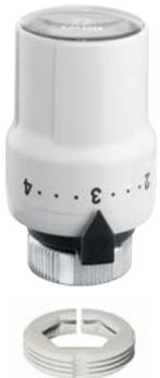
Tête thermostatique pour robinets de radiateurs; capteur incorporé avec élément sensible liquide. Avec affichage digital à cristaux liquides de la température ambiante. Pour robinet séries 338, 339, 401, 402, 421, 422, 455, 220, 221, 222, 223, 224, 225, 226 et 227. Échelle de réglage graduée de \* à 5 correspondant à une plage de température de 7°C à 28°C. Indicateur de la température ambiante de 16°C à 26°C. Avec adaptateur.
