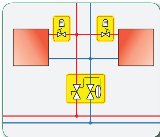
L'installazione della valvola termostatica con preregolazione prevede l'uso abbinato di regolatori  $\Delta P$  posizionati alla base delle colonne.
