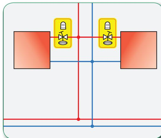
L'installazione della valvola termostatica dinamica non richiede ulteriori dispositivi per la regolazione del  $\Delta P$  sull'impianto poichè è già integrato all'interno del suo vitone.
