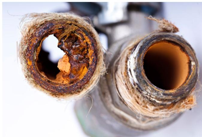
**Scambiatori:** Sulle superfici metalliche degli scambiatori si formano incrostazioni che diminuiscono lo scambio termico. 1 mm di calcare depositato all'interno di uno scambiatore diminuisce l'efficienza di scambio e aumenta i consumi energetici del 10%.
