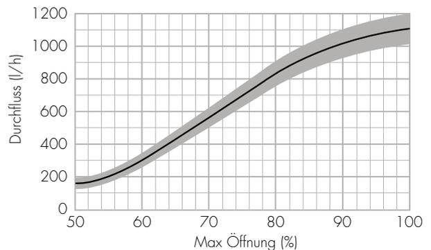
Die Einstellung eines maximalen Öffnungsgrades (%) erfolgt über den Parameter t04 im technischen Menü.
