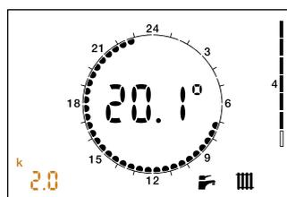
(\* Sollten diese Einstellungen nicht veränderbar sein, muss im technischen Menü (siehe „Zugriff auf technisches Menü“ im folgenden Teil), der Parameter t07 auf 0 eingestellt werden. Der Parameter t07 = 1 „gefriert“ die Betriebseinstellungen des Abnehmersatelliten um versehentliche Verststellungen durch den Benutzer zu vermeiden.
