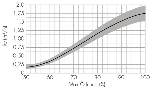
Die Einstellung eines maximalen Öffnungsgrades (%) erfolgt über den Parameter t03 im technischen Menü.
