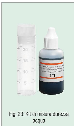
Fig. 23: Kit di misura durezza acqua
