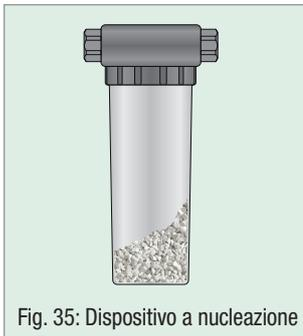
Fig. 35: Dispositivo a nucleazione
