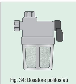
Fig. 34: Dosatore polifosfati
