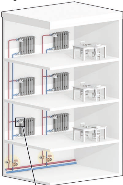
Impianto con valvole termostattizzabili con preregolazione
