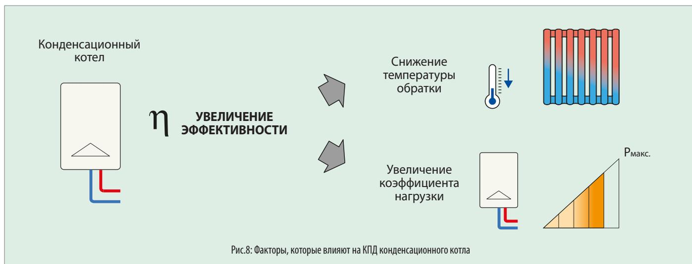
Рис.8: Факторы, которые влияют на КПД конденсационного котла
