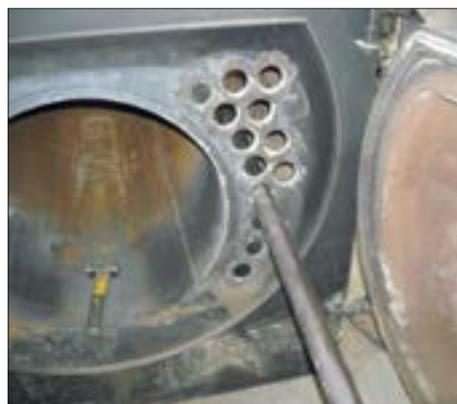
Sono questi, ad esempio, i **fenomeni che hanno causato la rottura di molte caldaie a fascio tubiero nelle zone di saldatura dei tubi**: cioè nelle zone meno irrigate della caldaia e quindi più esposte alle sollecitazioni termiche e agli stress di cui sopra.
