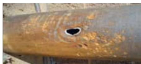
Tali correnti sono causate da mezzi o sistemi distributivi che usano conduttori a contatto con il terreno, ad esempio: ferrovie, tramvie e cavi ad alta tensione.
