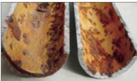
Possono compromettere la tenuta dei tubi, delle caldaie e dei corpi scaldanti.
