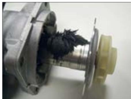
Fatto questo che, se non adeguatamente contrastato, può comportare un accumulo permanente di magnetite sui rotori e quindi causare una netta caduta di resa delle pompe, nonché una loro rapida usura e danni irreparabili.
