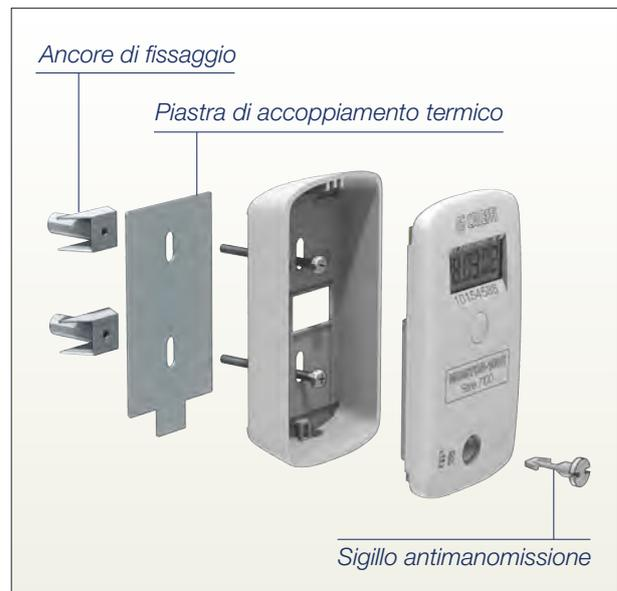
I ripartitori devono essere installati in **posizioni significative per il rilievo della temperatura media superficiale dei corpi scaldanti**. A tal fine possono essere utilizzate le indicazioni sotto riportate.
