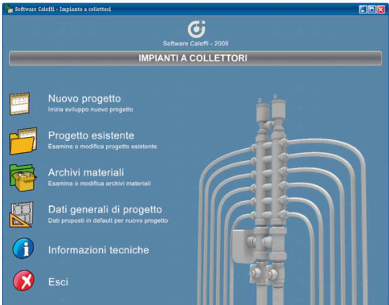
Schermata di avvio del nuovo programma per il dimensionamento degli impianti a corpi scaldanti
