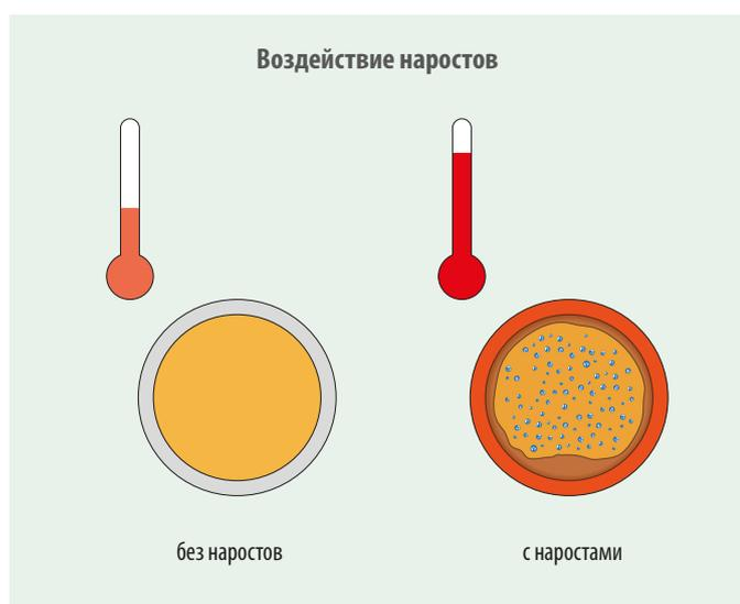
Фактически, увеличение даже на несколько градусов температуры отводящих газов значительно снижает способность конденсации котлов и, следовательно, их КПД.
