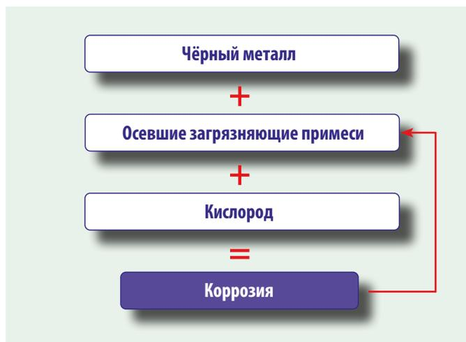
Общая коррозия приводит к образованию **магнетита**, типичного осадка темно-серого цвета, который часто находится в системах отопления и в старых отопительных железных или чугунных радиаторах (термосифонах).
