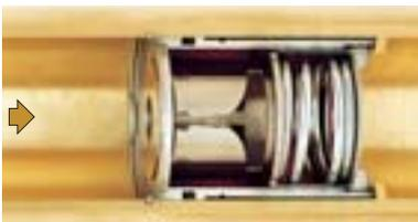
Au-delà de la plage de travail le piston comprime complètement le ressort et ne laisse au fluide que l'orifice central comme voie de passage. Comme dans le premier cas, le piston sert de régulateur fixe. Le débit qui traverse l'AUTOFLOW ne dépend donc que de la pression différentielle.
