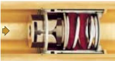
Si la pression différentielle est comprise dans le plage de travail, le piston comprime le ressort et offre au fluide une section libre pour le passage en mesure de permettre le débit défini par l'AUTOFLOW.
