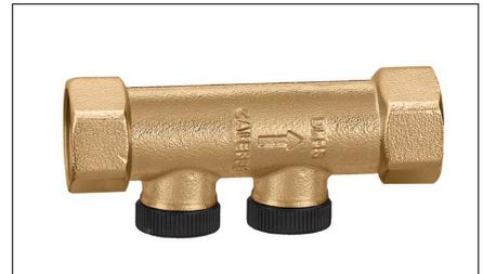
La doble válvula de retención se puede utilizar para la protección contra el riesgo de contaminación del agua hasta la categoría 2. Consta de una válvula de retención aguas arriba (1) y otra aguas abajo (2), con dos tomas de control (3) y (4). Aunque mantenga el nivel de protección de la categoría 2, a veces se elige para aplicaciones de equipos para varios mercados que reconocen su doble sellado interno.
