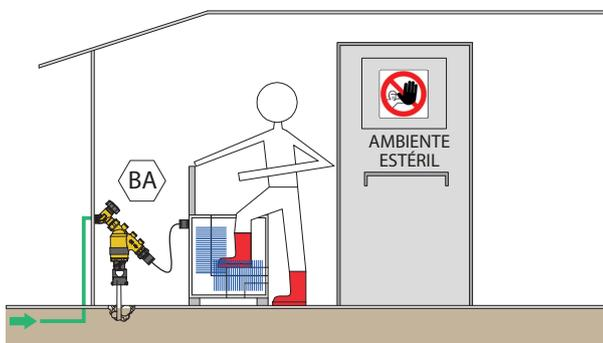
En esta aplicación, la máquina funciona con agua y productos químicos desinfectantes y el fluido alcanza la categoría 4. Debe colocarse un dispositivo de tipo BA en el punto de conexión.
