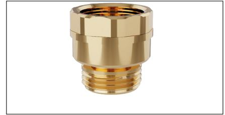
El dispositivo de protección para aparatos sanitarios con ventilación atmosférica se utiliza en unión de tubería flexible con riesgo de inmersión. La protección contra la categoría 3 se limita únicamente al sifonaje inverso. No protege contra la contrapresión.
