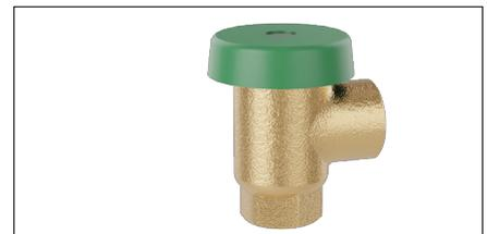
La válvula rompe-vacío evita la contaminación de la red de agua potable por sifonaje de agua contaminada. La protección de las categorías 1, 2 y 3 se limita únicamente al sifonaje inverso. No protege contra la contrapresión.
