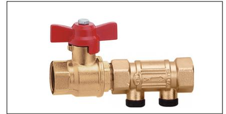
As válvulas de retenção antipoluição tipo EA podem ser utilizadas para proteção contra o risco de contaminação da água até à categoria 2. A válvula de retenção antipoluição é constituída pelo corpo da válvula (1), uma válvula de retenção (2) e, eventualmente, uma ou mais entradas de verificação (3) para os procedimentos de controlo do funcionamento e descarga da instalação. A retenção (2) delimita duas zonas diferentes: uma a montante ou de entrada (A), e uma zona a jusante ou de saída (B).
