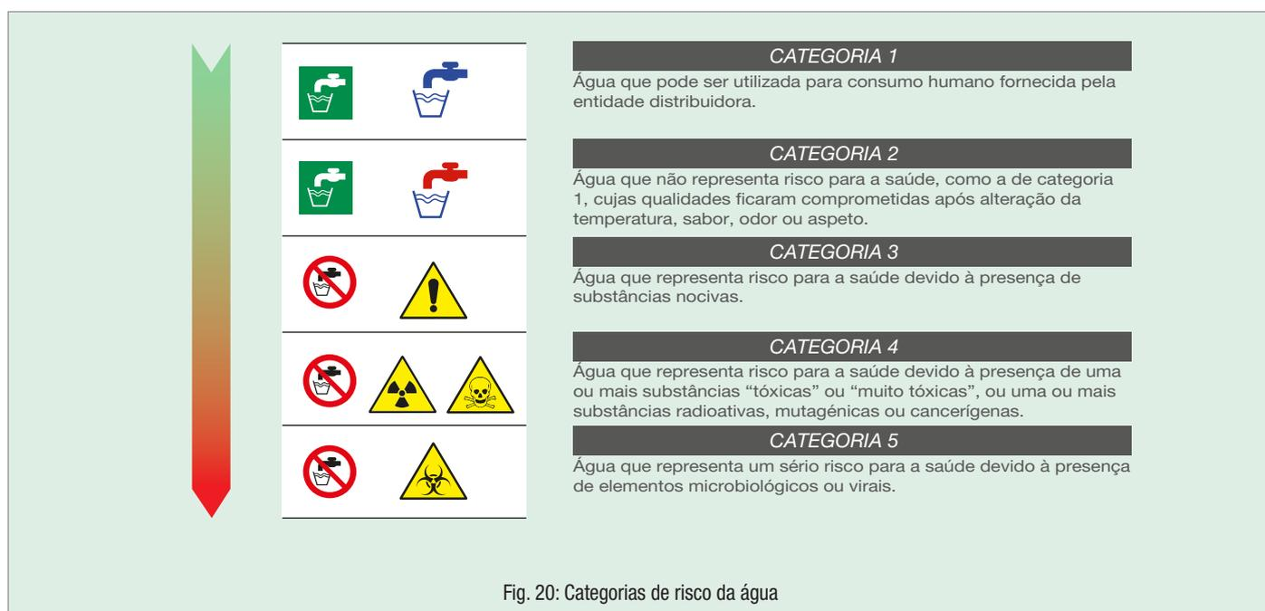
Com base nesta classificação, devem ser colocados dispositivos antirrefluxo adequados nos circuitos de distribuição da água. A norma EN 1717 descreve o princípio de funcionamento e os requisitos mínimos dos dispositivos aptos para proteger a rede de água destinada ao consumo humano contra o refluxo de água pertencente a uma das quatro categorias superiores.
