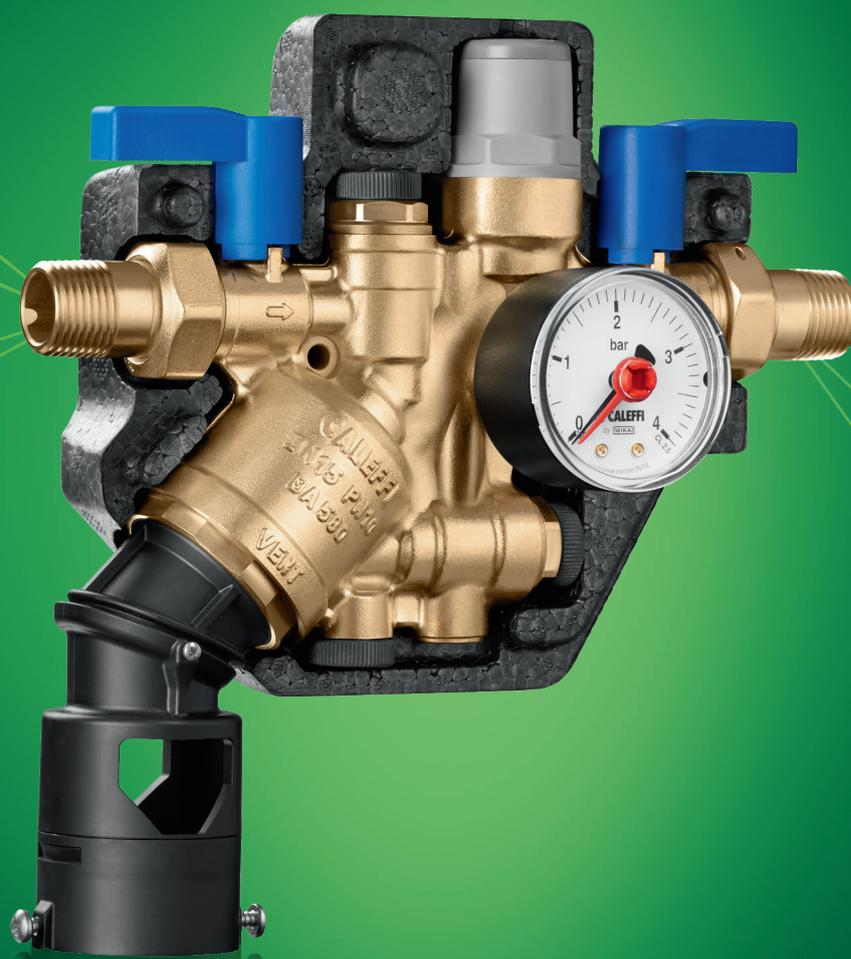
Manter a pressão constante, efetuar automaticamente a reintegração da água em falta e impedir o refluxo de água para a rede de alimentação. São estas as funções do **grupo compacto de enchimento automático com desconector tipo BA série 580011**. Fácil de instalar, garante a eficiência das instalações de aquecimento com circuito fechado. **GARANTIA CALEFFI.**
