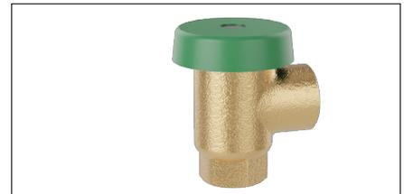
A válvula antivácuo impede a contaminação da rede de água potável devida à sifonagem de água poluída. A proteção relativa às categorias 1, 2 e 3 limita-se apenas à sifonagem inversa. Não protege contra fenómenos de contrapressão.
