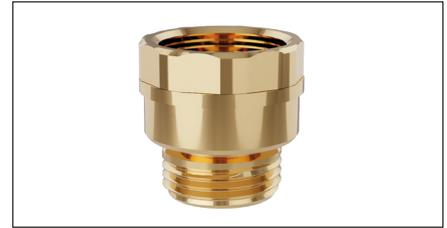
A válvula quebra-vácuo para aparelhos sanitários com purga de ar é utilizada juntamente com um tubo flexível em risco de imersão. A proteção contra a categoria 3 limita-se apenas à sifonagem inversa. Não protege contra fenómenos de contrapressão.
