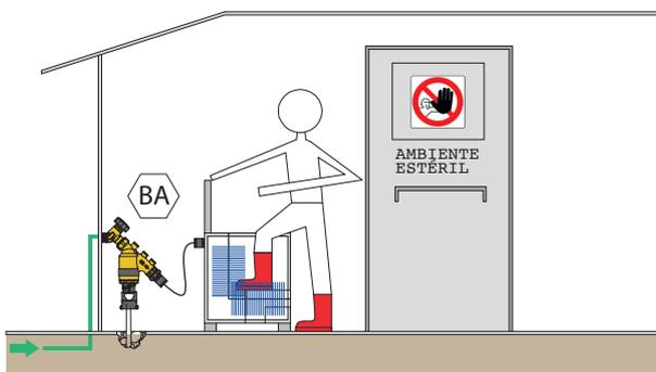
Nesta aplicação, a máquina trabalha com água e substâncias químicas desinfetantes. O fluido contido atinge a categoria 4. Um dispositivo tipo BA deve ser posicionado no ponto de ligação.
