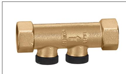
A válvula de dupla retenção pode ser utilizada para proteção contra o risco de contaminação da água até à categoria 2. Possui uma retenção a montante (1) e uma a jusante (2), com duas tomadas de verificação (3) e (4). Embora mantendo o nível de proteção de categoria 2, é por vezes escolhida para aplicações com equipamentos destinados a vários mercados que reconhecem a sua dupla vedação interna.
