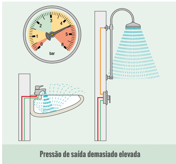
A fim de garantir uma distribuição correta nos pontos de utilização, a rede de abastecimento de água sanitária deve ser dimensionada de forma a assegurar, em toda a sua extensão, a pressão e o caudal de projeto.
