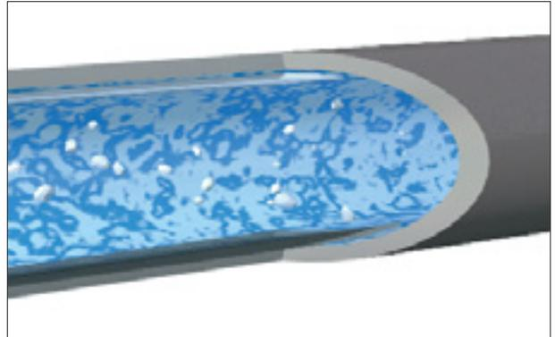
Por el estrés térmico, la cal puede desprenderse y aglutinarse en las piezas de ajuste (grifos de radiador, etc.) e impedir su buen funcionamiento.
