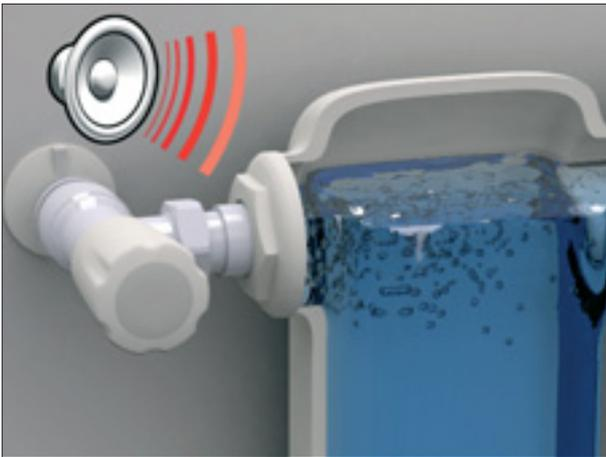
Una vez purgado el aire, hay que añadir agua en la instalación para restablecer la presión. El agua calcárea favorece las incrustaciones y éstas dificultan el intercambio térmico (1 mm de cal implica un consumo de energía 7% mayor).
