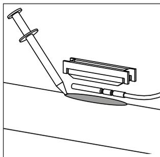
Appoggiare la sonda e il portasonda alla tubazione e fissarli tramite la fascetta in dotazione.
