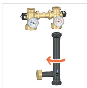
Nelle versioni con circolatore UPM3K Auto 25-70 ruotare il circolatore sul suo asse finché non è possibile chiudere la coibentazione prestando attenzione a posizionare il foro anticondensa verso il basso. In caso di installazioni orizzontali o capovolte, è necessario ruotare la parte elettronica della circolatore, svitando le quattro viti e assicurandosi di mantenere l'albero motore in posizioni orizzontale e il foro scarico condensa verso il basso.
