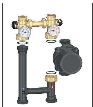
3. Posizionare il tubo di collegamento a destra, ruotandolo di 180° rispetto al suo asse.
