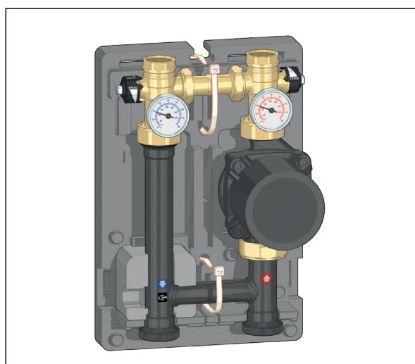
Nel montaggio del guscio posteriore al gruppo si consiglia di utilizzare due fascette, come indicato in figura, in modo da garantire una perfetta aderenza della coibentazione alle tubazioni e diminuire il più possibile la probabilità di formazione di condensa.
