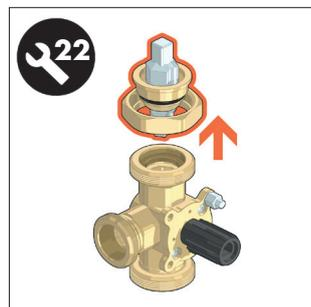
6. Ruotare la valvola di 180°. Inserire il bocchettone nell'attacco superiore. Avvitare fino a battuta meccanica.
