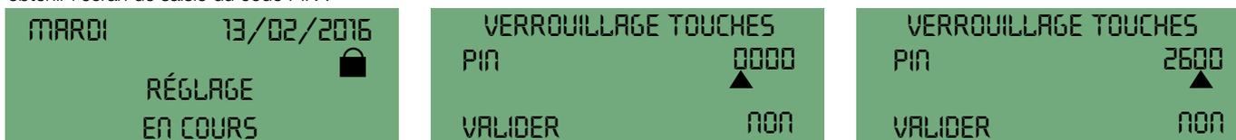
Pour saisir le code, sélectionner le premier chiffre à l'aide des touches "UP" et "DOWN" et confirmer le numéro par OK. On passe ainsi à la sélection du deuxième chiffre et ainsi de suite.
