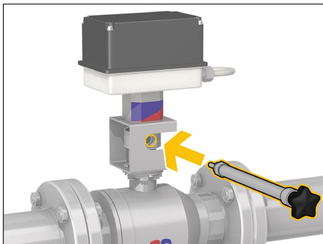
2) Visser la poignée appropriée (fournie) dans l'orifice du pivot de blocage.
