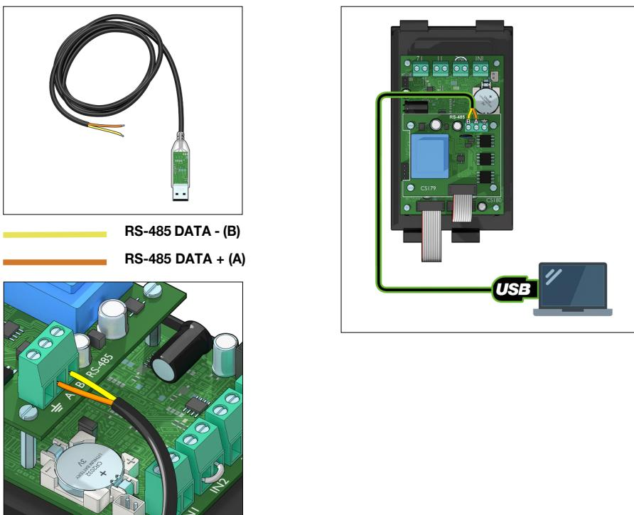
**Una rete di comunicazione RS-485 dovrebbe essere realizzata in conformità alle prescrizioni di standard EIA RS-485 (qualsiasi altra configurazione è a discrezione dell'operatore che la realizza).**
