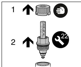
Sollevare il coperchio di blocco del flussometro (1) con l'aiuto di un cacciavite. Svitare il flussometro (2) utilizzando una chiave fissa da 22 mm
