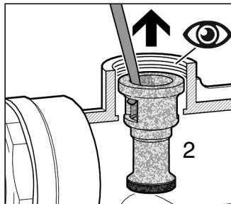
Estrarre il condotto del flussometro (2), in materiale plastico, tramite l'uso di un idoneo attrezzo ad uncino, inserendolo nella finestrella di passaggio del fluido. Prestare attenzione a non danneggiare la filettatura interna
