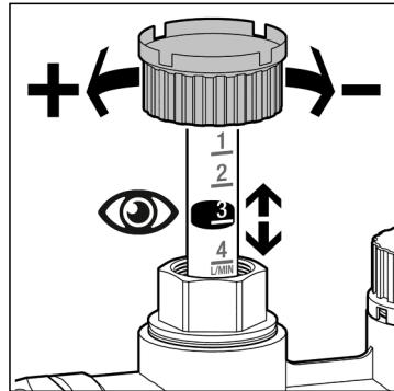
Mediante la valvola di regolazione con apposito condotto conico, la portata ai singoli circuiti può essere regolata con precisione al valore di progetto, valore letto direttamente sul singolo flussometro con scala 1÷4 l/min. In questo modo si semplifica e velocizza l'operazione di taratura del circuito, senza la necessità di grafici di riferimento.
