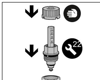
Avvitare il nuovo flussometro (coppia massima di serraggio: 10 N·m) e riposizionare il blocco flussometro.
