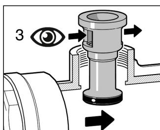
Sostituire il condotto con il nuovo condotto presente in confezione, facendo attenzione a posizionare la finestrella (3) nel senso del flusso, come in figura.
