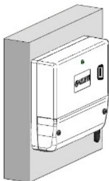
Visualizzato il led verde fisso del concentratore dati è possibile estrarre il dispositivo USB
