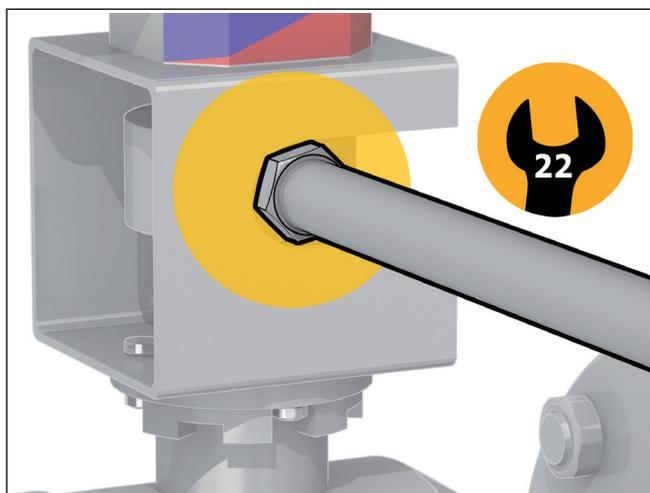
3) Bloquer le levier en position à l'aide du contre-écrou approprié et serrer avec une clé fixe de 22 mm.
