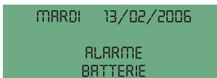
Si les paramètres lus ne respectent pas les valeurs prévues, cela signifie que la batterie est endommagée et doit être remplacée.
