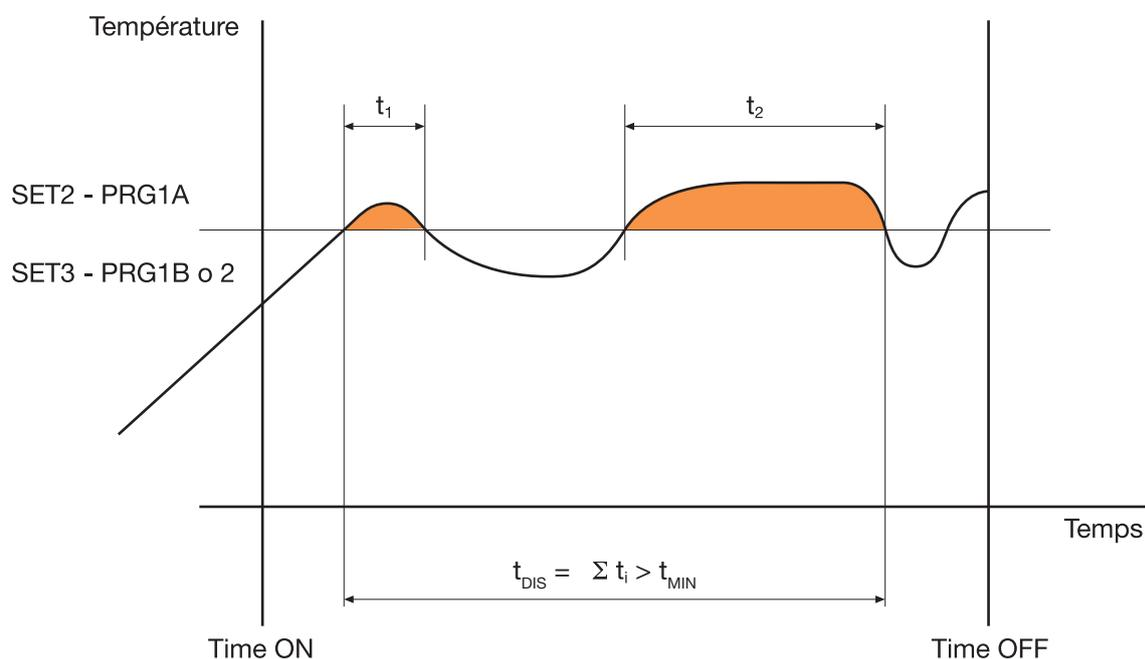
Si la fenêtre temps (Time OFF - Time ON) indique un temps effectif de désinfection t<sub>DIS</sub> supérieur au t<sub>MIN</sub> programmé, la désinfection s'arrête avec un résultat positif. L'appareil quitte automatiquement cet état et se remet en mode régulation.
