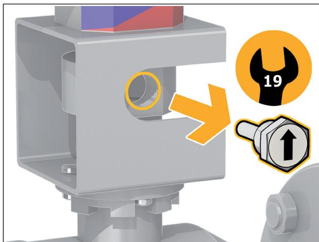
1) Dévisser la tige filetée de blocage à l'aide d'une clé à fourche de 19 mm.
