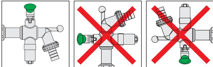
Prije ugradnje uređaja, provjerite da je priključni spoj čist i bez nečistoća, koje bi se mogle nagomilati u instalaciji. Uređaj mora biti instaliran samo u okomitom položaju, kao što je prikazano u shemci. Samo na taj način može voda pravilno i slobodno teći prema dolje.
