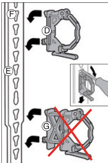
Il supporto a profondità maggiore (G) da installare nella parte inferiore della zanca deve essere sostituito dal distanziale (H) e dal supporto a profondità ridotta (D).
