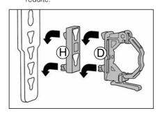
Placer le collecteur sur le support et le bloquer sur la forme octogonale.
