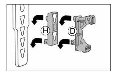
Placer le collecteur sur le support et le bloquer sur la forme octogonale.
