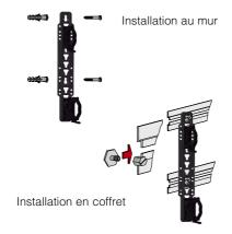
La paire de support de fixation en matériau composite peut être utilisée soit en coffret code 659..4, 659..5 et 661..5 soit directement au mur.
