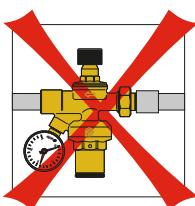
Der Druckminderer in der Füllmatur ist bei Inbetriebsetzung der Anlage auf den Fülldruck des Membran-Ausdehnungsgefäßes einzustellen. Die Einstellung des Druckminderers erfolgt an der Stellschraube im Inneren der Federhaube (Linksdrehung - niedrigerer Druck, Rechtsdrehung - höherer Druck). Während des Füllvorganges kann die Arbeitsweise der Füllmatur am Manometer genau beobachtet werden.
