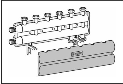
2. Posizionare il collettore sulle staffe (non fornite in confezione) fissandolo con apposito kit (non fornito in confezione). Ultimare i collegamenti idraulici e verificare la tenuta dell'impianto. Richiudere incastrando delicatamente la parte anteriore della coibentazione come indicato in figura.
