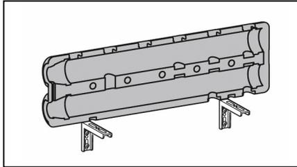
1. Fissare a muro le staffe (non fornite in confezione) mediante appositi tasselli. Posizionare a muro la parte posteriore della coibentazione, utilizzabile sia per impianti di riscaldamento che raffreddamento.
