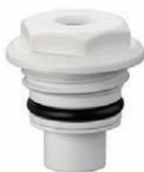
Per la sostituzione del vitone (1) è sufficiente rimuovere con cautela quello danneggiato tramite una chiave esagonale da 14 mm ed avvitare il nuovo con una coppia di serraggio di 1,5 N·m.
