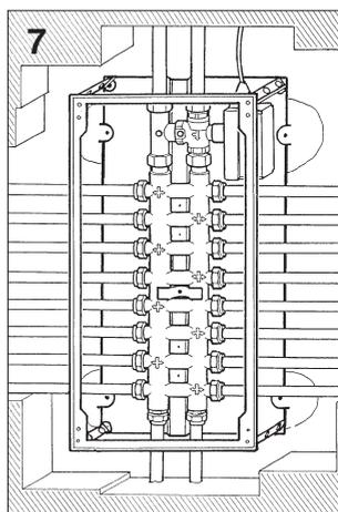
**7.** Dopo aver posizionato la parte idraulica, occorre riposizionare il telaio superiore reinsertando nei loro alloggiamento i piolini.
