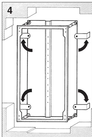
**4.** Inserire la cassetta nel vano di alloggiamento nella giusta posizione ed alla giusta profondità, ruotare le zanche verso l'esterno della cassetta e procedere alla loro muratura.
