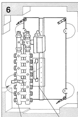
**6.** Presentare il collettore in cassetta per scegliere la giusta posizione di fissaggio della staffa di supporto fornita in confezione.
