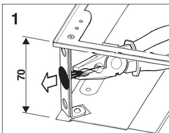
2. La cassetta viene fornita di serie con una profondità di 70 mm.
