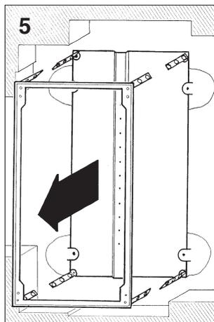
**5.** Per agevolare l'installazione della parte idraulica occorre rimuovere il telaio superiore della cassetta, togliendo i piolini come già spiegato al punto 2.
