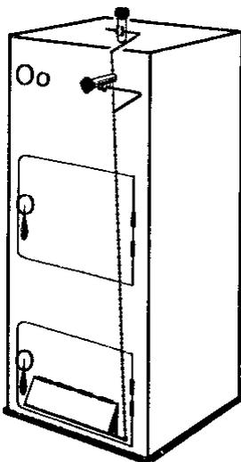
O regulador de tiragem, controlando automaticamente o ar comburente, regula a intensidade da combustão segundo as necessidades da instalação, proporcionando assim uma temperatura ambiente confortável e uma economia de combustível considerável.
