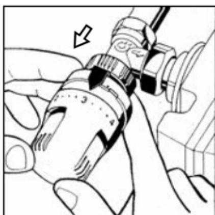
**3.** Remettre la virole en position. La tête peut être manoeuvrée de la position zéro jusqu'à la position réglée.
