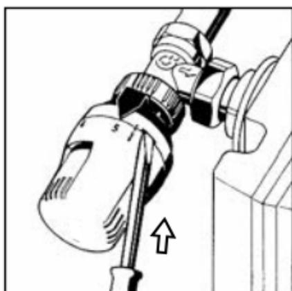
**1.** Tourner le tête jusqu'en ouverture complète (position 5). Avec un tournevis, dégager la virole en la pousant à fond vers le corps du robinet.
