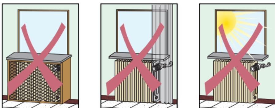
Le bulbe sensible ne doit pas être installé dans des niches, dans des coffrages ou derrière des rideaux, ni exposé directement aux rayons du soleil, qui en fausseraient le fonctionnement.
