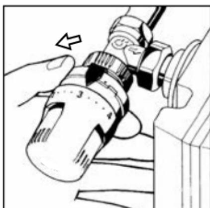
**2.** Tourner la tête jusqu'à la position d'ouverture maximale souhaitée. Tourner à fond la virole **dans le sens contraire des aiguilles d'une montre**.
