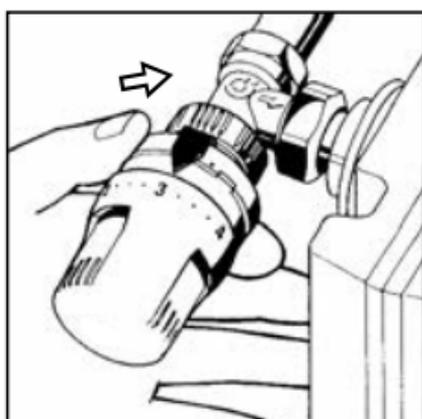
**2.** Tourner la tête jusqu'à la position souhaitée. Tourner à fond la virole **dans le sens des aiguilles d'une montre**.
