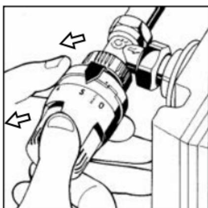
**2.** Tourner la tête en position "tout ouvert". Tourner à fond la virolle dans **le sens contraire des aiguilles d'une montre**. Les témoins RESET se retrouvent en face l'un de l'autre.
