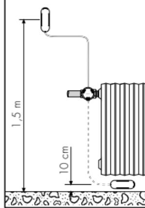
L'uso della testa termostatica con sensore a distanza richiede l'installazione di quest'ultimo rispettando le misure indicate nello schema.
