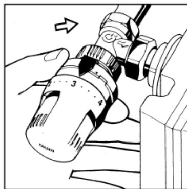
**2.** Posizionare la valvola alla temperatura desiderata e ruotare la ghiera **in senso orario** fino a battuta.
