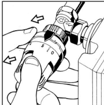
**2.** Ruotare la manopola in posizione tutta aperta, e la ghiera **in senso antiorario**, fino a battuta. Le frecce di RESET coincideranno.
