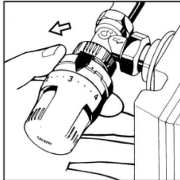
**2.** Ruotare la manopola fino alla nuova posizione di massima apertura desiderata (esempio pos. 3). Ruotare la ghiera **in senso antiorario** fino a battuta.
