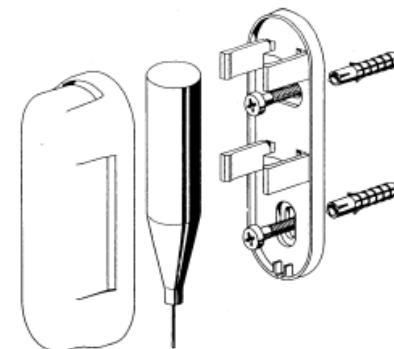
Den Sockel des Wandhalters mit dem mitgelieferten Befestigungsmaterial waagerecht oder senkrecht montieren. Dabei ist besonders darauf zu achten daß Kapillarrohr nicht zu quetschen, zerstören oder zu knicken und die eigens dafür mitgelieferten Reiter und Nägel zu benutzen.
