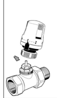
Per il montaggio del comando termostatico sulle valvole da 1" è necessario rimuovere l'adattatore (1) ed avvitare direttamente il comando sul corpo valvola.
