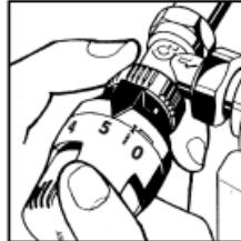
Prima dell'installazione del comando termostatico posizionare la manopola sul n° 5.
