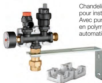
Chandelier en polymère avec accessoires pour installations de chauffage. Avec purgeur d'air, soupape de sécurité en polymère, manomètre, robinet d'arrêt automatique pour vase d'expansion et supports de fixation.
