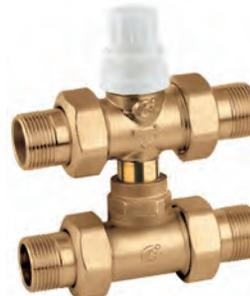
Vanne de zone trois voies avec té by-pass. Pouvant recevoir une tête électrothermique séries 6561, 6562 et 6563. Pmax d'exercice : 10 bar. Δp max : 1,2 bar. Plage de température : 0-95°C. Té équipé d'une buse U6. Entraxe réglable de 49 à 63 mm.
