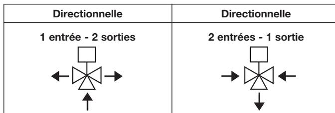
Schéma de fonctionnement vannes 638 - orifice en "L"
