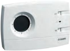
Thermostat programmable analogique digital. Alimentation par piles. Programmation journalier ou hebdomadaire. 2 niveaux de températures + antigel. Avec connexion pour programmeurs téléphoniques. Programmation minimale de 30 minutes. Contact sec de sortie : 8 (2) A. Indice de protection : IP 30. **Classe** : I-IV [Ecodesign Directive].
