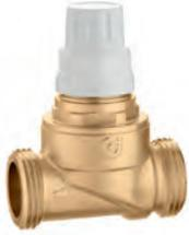
Vanne de zone deux voies pour grands débits. Pouvant recevoir une tête électrothermique séries 6561, 6562, 6563 et 6564. Pmax d'exercice : 10 bar. Δp max : 2,5 bar. Plage de température : 0-95 °C. PATENT PENDING.
