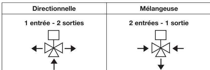
Schéma de fonctionnement vannes 638 - orifice en "T"
