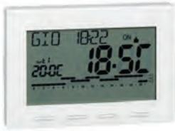
Thermostat programmable digital. Large écran rétro-éclairé et navigation par menu. Programmation hebdomadaire. Avec connexion pour programmeurs téléphoniques. 3 niveaux de températures + antigel. Programmation minimale de 30 minutes. Fonctionnement ON/OFF avec différentiel réglable de 0,2 à 2 °C ou proportionnel. Commutateur ÉTÉ - HIVER. Température réglable par pas de 0,1 °C. Contact sec de sortie : 5 (3) A / 250 V. Indice de protection : IP 30. **Classe** : I-IV [Ecodesign Directive].
