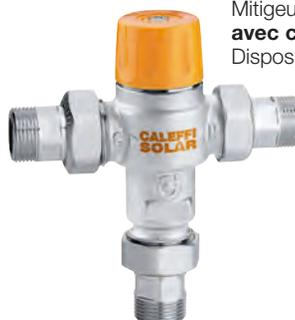
Mitigeur thermostatique réglable, avec clapets anti-retour et filtres. Dispositif avec sécurité anti-brûlure. Corps en laiton. Chromé. Raccords unions filetés mâles. Conforme aux normes NF 079 doc. 8, EN 15092, EN 1111, EN 1287. Pmax d'exercice : 10 bar. Tmax d'entrée : 100 °C.
