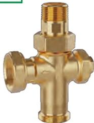
Connexion eau froide avec clapet pour mitigeur thermostatique série 5200. Corps en laiton "LOW LEAD" antidézincification CR. Raccordements entrée sortie eau froide : raccord union 1". Raccordement latéral : écrou tournant 1". Pmax d'exercice : 10 bar. Tmax d'entrée : 90 °C.
