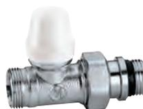
Té de réglage. Chromé. Pour tube cuivre, plastique simple et multicouches. Pmax d'exercice : 10 bar. Plage de température : 5-100 °C.
