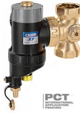
Pot de décantation magnétique avec filtre autonettoyant semi-automatique **avec by-pass.** Corps en technopolymère. Raccordements filetés femelle. **Orientable pour installations horizontales et verticales.** Robinet de vidange avec tétine. Pmax d'exercice : 3 bar. Plage de température : 0-90 °C. Lumière moyenne des mailles du filtre : 0,16 mm.
