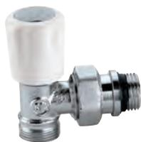
Robinet équerre thermostatisable, pouvant recevoir une tête électrothermique ou thermostatique. Chromé. Pour tube cuivre, plastique simple et multicouches. Pmax d'exercice : 10 bar. Plage de température : 5-100 °C.
