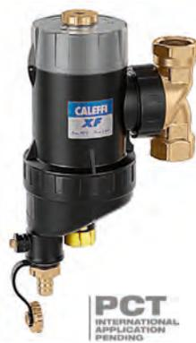
Pot de décantation magnétique avec filtre autonettoyant semi-automatique. Corps en technopolymère. Raccordements filetés femelle. **Orientable pour installations horizontales et verticales.** Robinet de vidange avec tétine. Pmax d'exercice : 3 bar. Plage de température : 0-90 °C. Lumière moyenne des mailles du filtre : 0,16 mm.
