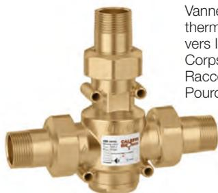
Vanne anticondensation avec contrôle thermostatique de la température de retour vers les générateurs à combustible solide. Corps en laiton. Raccords union mâle. Pourcentage maxi de glycol : 50 %. Pmax d'exercice : 10 bar. Plage de température : 5-100 °C. Tarage : 45 °C, 55 °C, 60 °C, 70 °C. Précision tarage : ± 2 °C. Température de fermeture à 100 % du by-pass : Tmix = Tset + 10°C = Tr.
