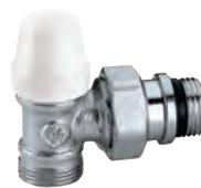
Coude de réglage. Chromé. Pour tube cuivre, plastique simple et multicouches. Pmax d'exercice : 10 bar. Plage de température : 5-100 °C.
