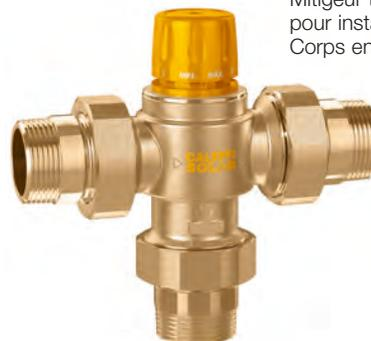
Mitigeur thermostatique réglable pour installations solaires centralisées. Corps en laiton antidé zincification CR. Raccords unions filetés mâles. Régulateur interne en technopolymère. Pmax d'exercice : 14 bar. Tmax d'entrée : 100 °C.
