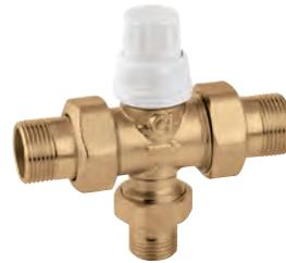
Vanne de zone trois voies. Pouvant recevoir une tête électrothermique séries 6561, 6562 et 6563. Pmax d'exercice : 10 bar. Δp max : 1,2 bar. Plage de température : 0-95°C.
