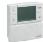
Thermostat d'ambiance numérique avec écran. Pouvoir de coupure du commutateur 5 (3) A. Fonctionnement ON/OFF avec différentiel réglable de 0,2 à 2 °C ou proportionnel. 2 niveaux de température + antigel. Commutateur ÉTÉ - HIVER. Température réglable par pas de 0,1 °C. Indice de protection : IP 30. **Classe** : I [Ecodesign Directive].
