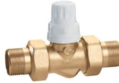
Vanne de zone deux voies. Pouvant recevoir une tête électrothermique séries 6561, 6562 et 6563. Pmax d'exercice : 10 bar. Δp max : 1,2 bar. Plage de température : 0-95°C.
