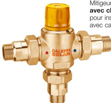
Mitigeur thermostatique avec clapets anti-retour pour installations solaires, avec cartouche extractible. Corps en laiton. Raccords unions filetés mâles. Pmax d'exercice : 14 bar. Tmax d'entrée: 110 °C.
