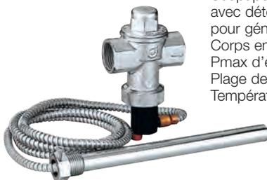
Soupape de sécurité thermique, avec détecteur à double sécurité, pour générateurs à combustible solide. Corps en laiton. Chromé. Pmax d'exercice: 10 bar. Plage de température : 5-110 °C. Température de tarage : 98 °C (0/-4 °C).
