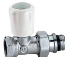
Robinet droit thermostatisable, pouvant recevoir une tête électrothermique ou thermostatique. Chromé. Pour tube acier. Pmax d'exercice : 10 bar. Plage de température : 5-100 °C.
