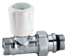
Robinet droit thermostatisable, pouvant recevoir une tête électrothermique ou thermostatique. Chromé. Pour tube cuivre, plastique simple et multicouches. Pmax d'exercice : 10 bar. Plage de température : 5-100 °C.
