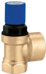
Membran-Sicherheitsventil für Brauchwasser. IG-IG-Anschlüsse. Ansprechdruck 20 %. Schließabweichung 20 %. Arbeitsmedien: Wasser. Temperaturbereich: 5–95 °C.
