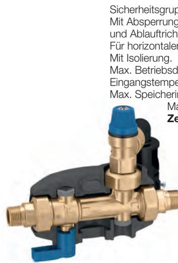
Sicherheitsgruppe DN 15 für Warmwasserbereiter. Mit Absperrung, kontrollierbarem Rückschlagventil und Ablauftrichter. Für horizontalen und vertikalen Einbau. Mit Isolierung. Max. Betriebsdruck: 10 bar. Eingangstemperatur: 40 °C. Max. Speicherinhalt: 200 l. Max. Heizleistung WW-Bereiter: 75 kW. **Zertifiziert nach EN 1488.**
