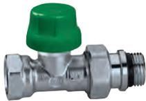
Dynamisches Thermostatventil für den Betrieb mit Thermostatköpfen und elektrothermischen Stellantrieben. Verchromt. Durchgangsform im IG-Anschluss. TH-Kopf Aufnahme AG 30 x 1,5. Max. Betriebsdruck: 10 bar. Temperaturbereich: 5–95 °C.
