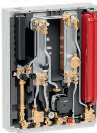
Dezentrale Wärmeübergabestation. Mit Heizungssystemtrennung. Zur Wandmontage, Aufputz. Heizungstemperaturbereich: 25–45 °C und 45–75°C. Max. Warmwasserleistung: 24 l / min Max. Betriebsdruck: 16 bar. Max. Primär-Dp: 6 bar. **Abmessungen (B x H x T) 490 x 630 x 245 mm.**
