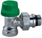
Dynamisches Thermostatventil für den Betrieb mit Thermostatköpfen und elektrothermischen Stellantrieben. Verchromt. Eckform mit IG Anschluss. TH-Kopf Aufnahme AG 30 x 1,5. Max. Betriebsdruck: 10 bar. Temperaturbereich: 5–95 °C.
