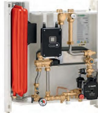
Dezentrale Wärmeübergabestation. Mit Heizungssystemtrennung. Zur Wandmontage, Aufputz. Heizungstemperaturbereich: 25–45 °C und 45–75°C. Max. Betriebsdruck: 16 bar. Max. Primär-Dp: 1,5 bar. Warmwasserbereitung mit separaten WW-Speicher (nicht im Lieferumfang). **Abmessungen (B x H x T) 550 x 630 x 265 mm.**
