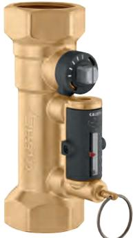
Strangregulierungsventil mit Durchflussmesser. Direkte Ablesung der Durchflussmenge. Ventilgehäuse und Durchflussmesser aus Messing. Kugelventil für Durchflussmengenregelung. Durchflussmesser mit Skala und Durchflussmengenanzeige.
