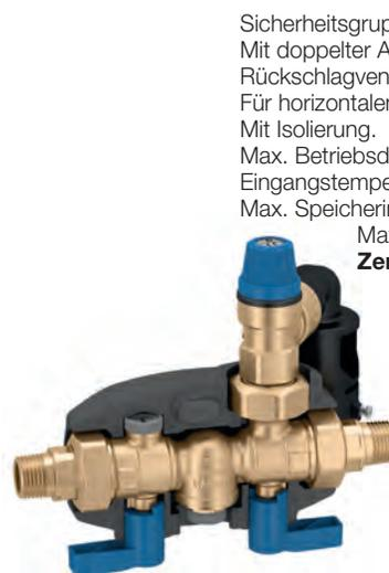
Sicherheitsgruppe DN 20 für Warmwasserbereiter. Mit doppelter Absperrung, kontrollierbarem Rückschlagventil und Ablauftrichter. Für horizontalen und vertikalen Einbau. Mit Isolierung. Max. Betriebsdruck: 10 bar. Eingangstemperatur: 40 °C. Max. Speicherinhalt: 1000 l. Max. Heizleistung WW-Bereiter: 150 kW. **Zertifiziert nach EN 1488.**
