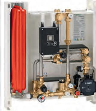
Dezentrale Wärmeübergabestation. Mit Heizungssystemtrennung. Zur Wandmontage, Aufputz. Heizungstemperaturbereich: 25–45 °C und 45–75°C. Max. Warmwasserleistung: 18 l / min (SATK30103HE) Max. Warmwasserleistung: 27 l / min (SATK30105HE) Max. Betriebsdruck: 16 bar. Max. Primär-Dp: 1,65 bar. **Abmessungen (B x H x T) 550 x 630 x 265 mm.**
