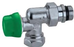
Dynamisches Thermostatventil für den Betrieb mit Thermostatköpfen und elektrothermischen Stellantrieben. Verchromt. Für Stahlrohre. TH-Kopf Aufnahme AG 30 x 1,5. Max. Betriebsdruck: 10 bar. Temperaturbereich: 5–95 °C.
