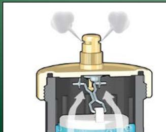
L'accumularsi delle bolle d'aria nel corpo valvola provoca la discesa del galleggiante e quindi l'apertura dell'otturatore. In questo modo l'aria viene sfogata automaticamente.
