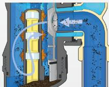
3. À la sortie de la chambre de traitement, le fluide caloporteur passe par un filtre, qui bloque mécaniquement toutes les impuretés résiduelles présentes dans le fluide.
