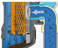
2. Un barreau magnétique, située dans la zone centrale, capture la magnétite et les impuretés ferreuses même des plus petites tailles.
