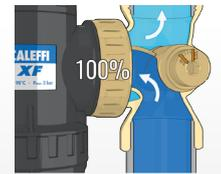
Se recomienda una filtración del 100 % durante la puesta en marcha y las primeras semanas de funcionamiento de la instalación. En la fase de "mantenimiento", el dispositivo se puede regular en función bypass para obtener un Kv mayor.
