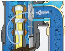
3. Al salir de la cámara de tratamiento, el fluido caloportador pasa por un filtro que bloquea mecánicamente todas las impurezas residuales del fluido.
