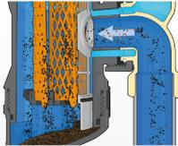
2. En la zona central hay una sonda magnética que captura la magnetita y las impurezas ferrosas hasta el tamaño más pequeño.
