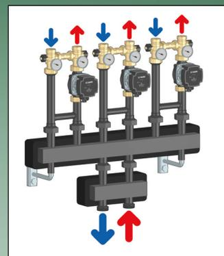
Pour installer le séparateur hydraulique, respecter impérativement le sens du flux indiqué sur les figures ci-après.
