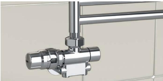
Le valvole termostattizzabili mono e bitubo possono essere rese termostatiche applicando il comando serie 200 al posto della manopola manuale. Il sensore incorporato nel comando termostatico è sufficientemente distante dal corpo valvola ed effettua una lettura corretta della temperatura ambiente senza essere influenzato dal calore irradiato dal corpo valvola stesso.
