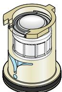
U ovom slučaju regulacioni klip ostaje u početnom položaju bez pritiska na oprugu itako omogućava fluidu maksimalni protok kroz poprečni presek. U praksi, klip deluje kao fiksni otvor i protok zavisi samo od diferencijalnog pritiska.
