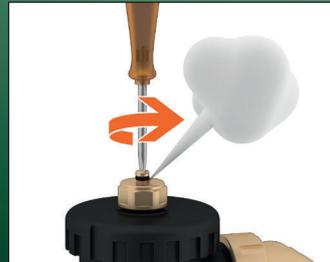
Durch Ausdrehen des oberen Stopfens mit einem entsprechenden Schraubendreher oder Flügelschlüssel kann die im oberen Teil des Gehäuses angesammelte Luft abgelassen werden.
