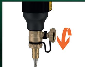
Den Ring, der die Magnete enthält, abnehmen und die Verunreinigungen – auch während des Anlagenbetriebs – mit dem mitgelieferten Schlüssel ablassen.
