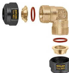
Raccordo curvo, meccanico a tenuta O-Ring per impianti solari. Per tubi in rame ricotto, rame crudo, ottone, acciaio dolce e acciaio inox. Pmax di esercizio: 16 bar.
