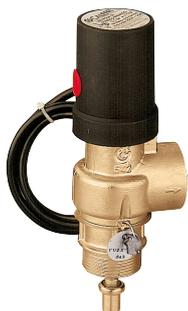
Valvola di scarico termico, ad azione positiva. Riarmo manuale per blocco bruciatore o allarme. Pressione di esercizio:  $0,3 \leq P \leq 10$  bar. Campo di temperatura: 5–100 °C. Temperatura di taratura 98 °C e 99 °C. Certificata e tarata a banco INAIL (Ex ISPESL).
