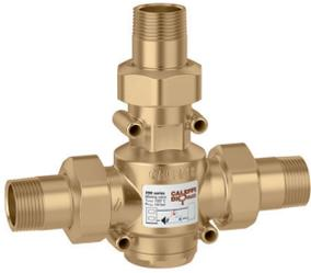
Valvola anticondensa con controllo termostatico della temperatura di ritorno verso generatori a combustibile solido.
