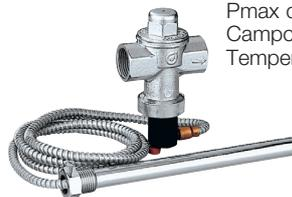
Valvola di scarico di sicurezza termica, con sensore a doppia sicurezza, per generatori a combustibile solido. P<sub>max</sub> di esercizio: 10 bar. Campo di temperatura: 5–110 °C. Temperatura di taratura 98 °C (0/-4 °C). Corpo in ottone.
