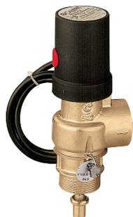
Valvola di scarico termico, ad azione positiva. Riarmo manuale per blocco bruciatore o allarme. Pressione di esercizio:  $0,3 \leq P \leq 10$  bar. Campo di temperatura: 5–100 °C. Temperatura di taratura 98 °C e 99 °C. Certificata e tarata a banco INAIL (Ex ISPESL). Potenzialità scarico: 1 1/2" x 1 1/4" - 136 kW. 1 1/2" x 1 1/2" - 419 kW.
